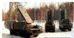
Jiný pohled na odpalovací zařízení. V pozadí vysoký stožár speciálního radiolokátoru na vyhledávání nízkoletících cílů.
